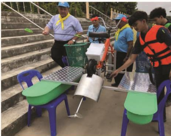
ต้นแบบอ้างอิงเรือหุ่นลอยจักรยานลมเก็บขยะ ( สำหรับ ใช้ในลำคลองน้ำนิ่งหรือลำคลองที่กระแสน้ำไม่แปรปรวน)
