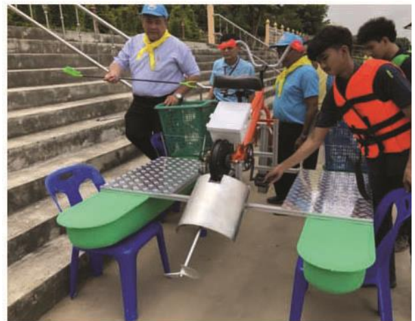
ต้นแบบอ้างอิงเรือหุ่นลอยจักรยานลมเก็บขยะ ( สำหรับ ใช้ในลำคลองน้ำนิ่งหรือลำคลองที่กระแสน้ำไม่แปรปรวน)
